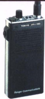
TOKYO HT-180 VHF 2 Mts. 1 W. Peso: 275 gr. / 2 canales EQUIPO DE BOLSILLO
