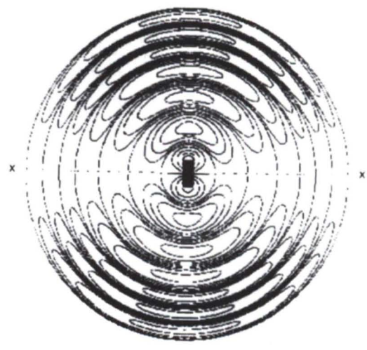
Fig. 4 Corriente de desplazamiento en un toroide
