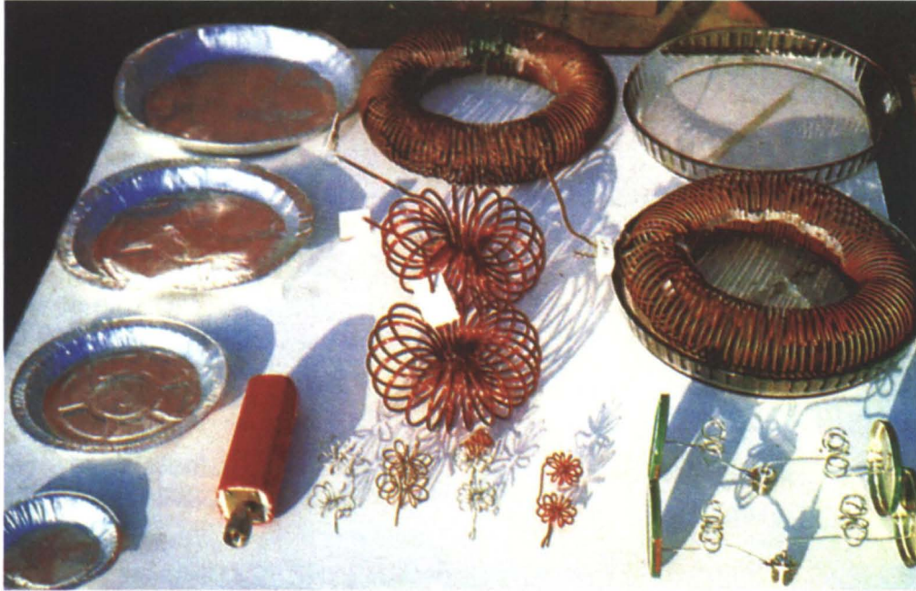
Una selección de componentes para antena toroidal: Los platos de aluminio para el campo fueron muy útiles como condensadores de terminación. En el centro, se pueden ver bobinas para 18 y 21 MHz, cada una debe estar en combinación con otra igual para formar un dipolo. En el centro superior una bobina para 80 m. y a su derecha una bandeja Pyrex. Los objetos alargados son antenas de VHF.
