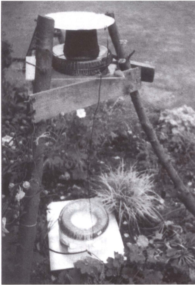
Doble toroide para 80m usando bandejas Pyrex para soportar las bobinas y placas de aluminio como sombreros capacitivos.
