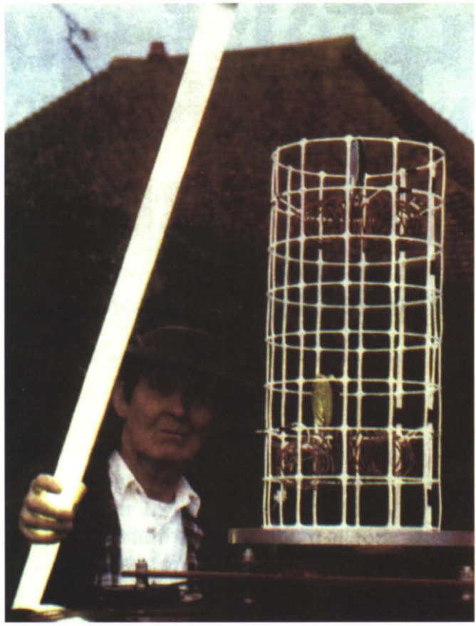
Peter Gold, G3LDO, de Radcom, muestra un tubo fluorescente iluminado mediante la RF de una antena móvil construida mediante el diseño de G2AJV.
