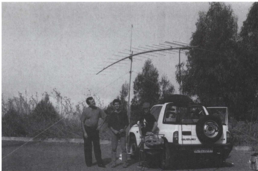
Leo, EA8ACW, Toño, SWL y Carlos, EA1DVY/EA8 (Las Palmas) Antena de 10'1 metro de BOOM de 17 elementos a 3 metros del suelo, en IL18FC: Participando en el concurso de la IARU R o 1 en VHF-94.
