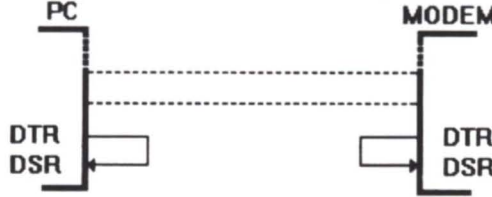
Fig.8: Conexión directa PC - MODEM
