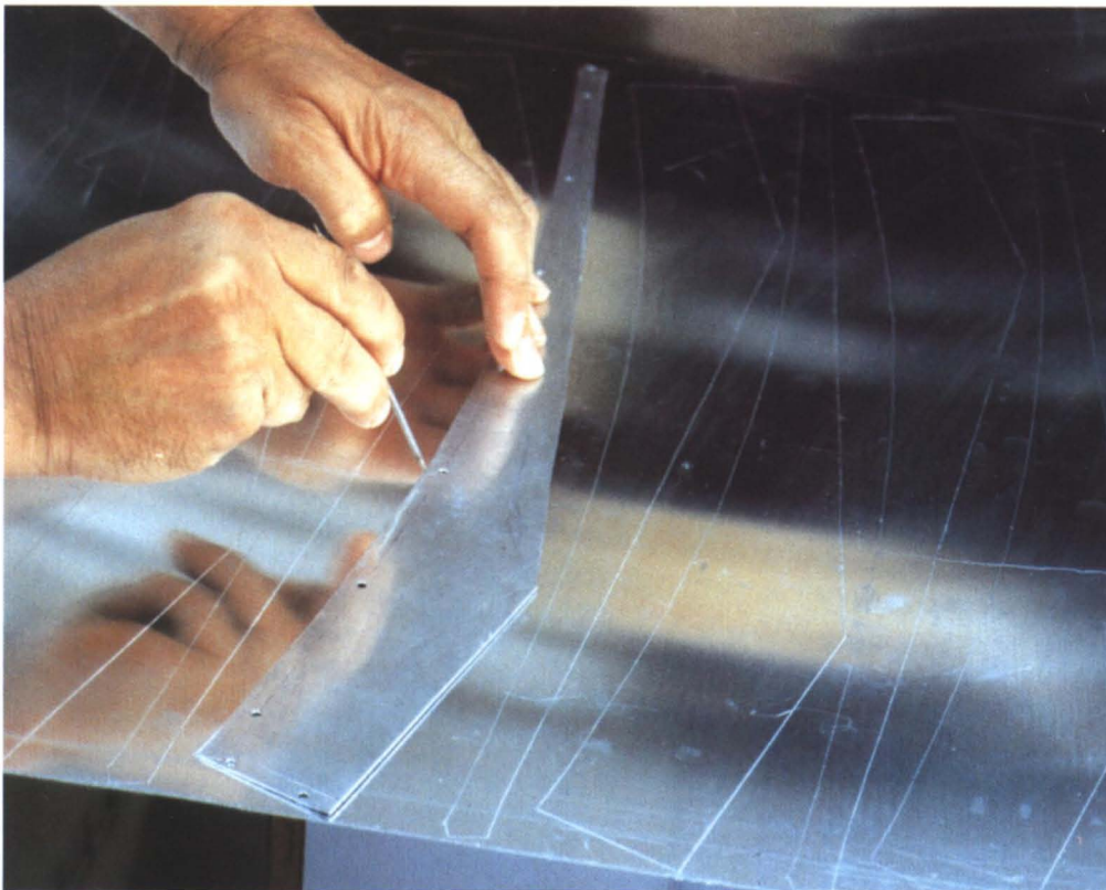
Con una punta acerada o punzón se marca en la chapa el corte de las demás cartelas.
