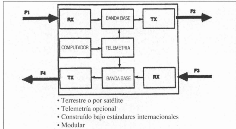
Figura 5. El repetidor o nodo de Gateway.
