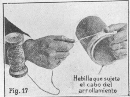
Fig. 17 La primera espira se sostiene sobre el cilindro de cartón mediante un lazo que impide resbalar. Después se enrolla el alambre sobre la armadura.
