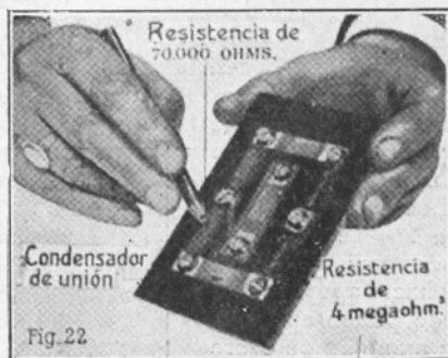
Trazado con lápiz blando de una resistencia de 70.000 ohmios entre dos contactos.
