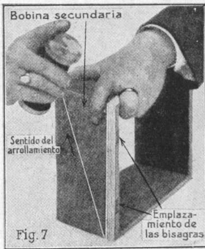
Fig. 7 Sentido del enrollamiento (de abajo arriba) de la bobina interior o secundaria.
