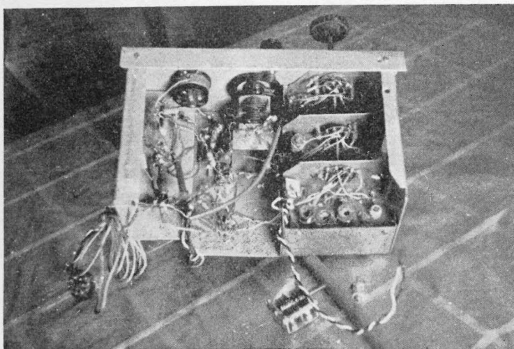
FIG. 2.—Puede verse la parte inferior del conversor; las bobinas van colocadas por el orden indicado en el texto, poniendo una hacia arriba y la otra hacia abajo de la plaquita de plástico que le sirve de soporte.
