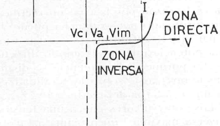
FIG. 2.—Rectificador protegido por avalancha: La tensión de perforación V_c es superior a V_a .
