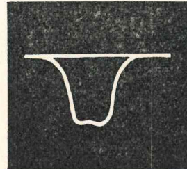
FIG. 21.—Respuesta total de una cadena F.I. (obtenida con vobulador).
