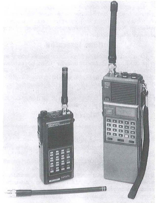
Fig. 60 – Transceptores portátiles de FM Kenwood y Yaesu. Este tipo de aparatos constituye una estación portátil completa, con adaptador de tono para captador telefónico y antena vertical flexible.
