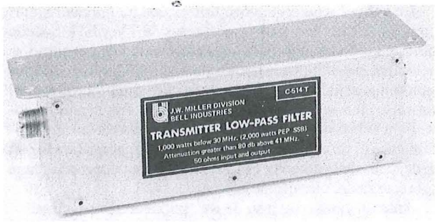
Fig. 118 – Esto es un filtro pasabajos. Se coloca en la línea de transmisión de cable coaxial que va desde el transmisor a la antena. El filtro pasabajos puede reducir la fuerza de los armónicos generados por el transmisor.
