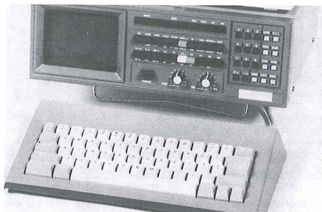
Fig. 106 – Este Tono EXL-5000E es un terminal de comunicaciones completo para RTTY. Envía y recibe CW, Baudot, ASCII y AMTOR, y tiene su propio teclado y pantalla.
