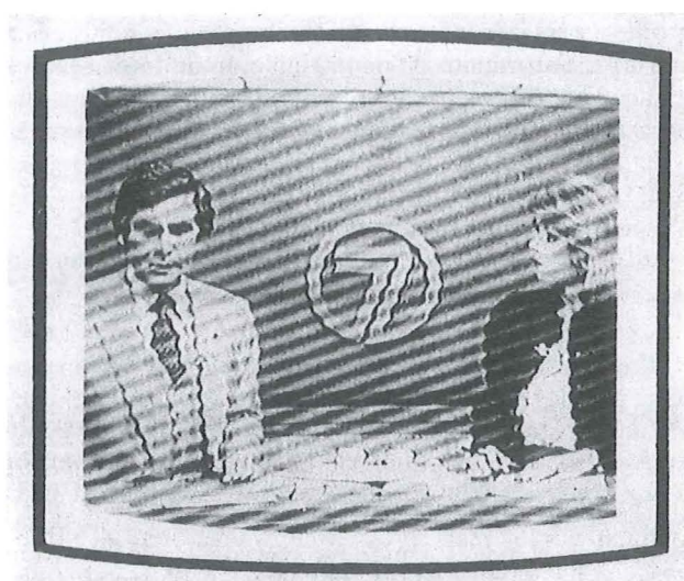
Fig. 117 – Rayas causadas por armónicos radiados desde un transmisor.
