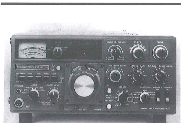
Fig. 55 – El transceptor Kenwood TS-820S utiliza válvulas 6146 en el amplificador final.
