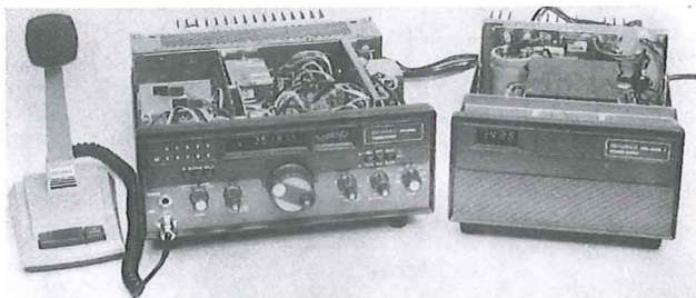
Fig. 57 – El transceptor Heath HW-5400 es un aparato para CW y SSB que se encuentra con frecuencia en el mercado de ocasión de EE.UU. Se han quitado las tapas para que se vean sus circuitos internos.
