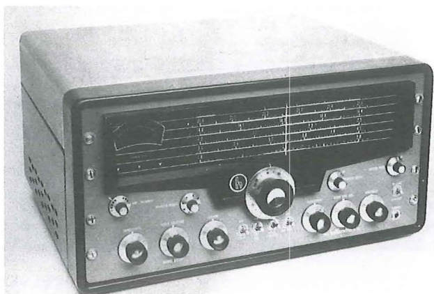
Fig. 51 – El receptor Hallicrafters SX-101, fabricado en 1958, pesa 34 kilos. Lo traemos aquí como ejemplo de una radio con dial de regla deslizante.
