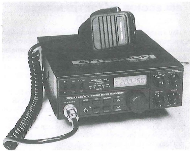
Fig. 56 – En A vemos al sucesor del Century 21, el Ten-Tec Century 22. En B se muestra un transceptor de 10 metros pequeño y barato. Las versiones de este aparato de radio pueden llevar el nombre de "Realistic" o "Uniden"
