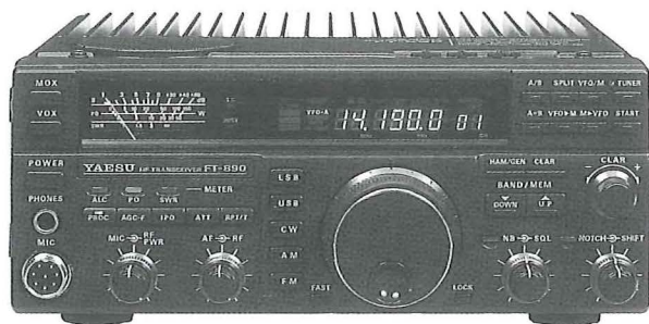
Fig. 53 – El Yaesu FT-890 es una maravilla de miniaturización moderna. El transceptor es de estado sólido en su totalidad y tiene una pantalla digital para visualizar las frecuencias. El aparato incorpora también un receptor de cobertura general y un transmisor de 100 vatios. Su tamaño confiere la posibilidad de instalarlo en móvil.
