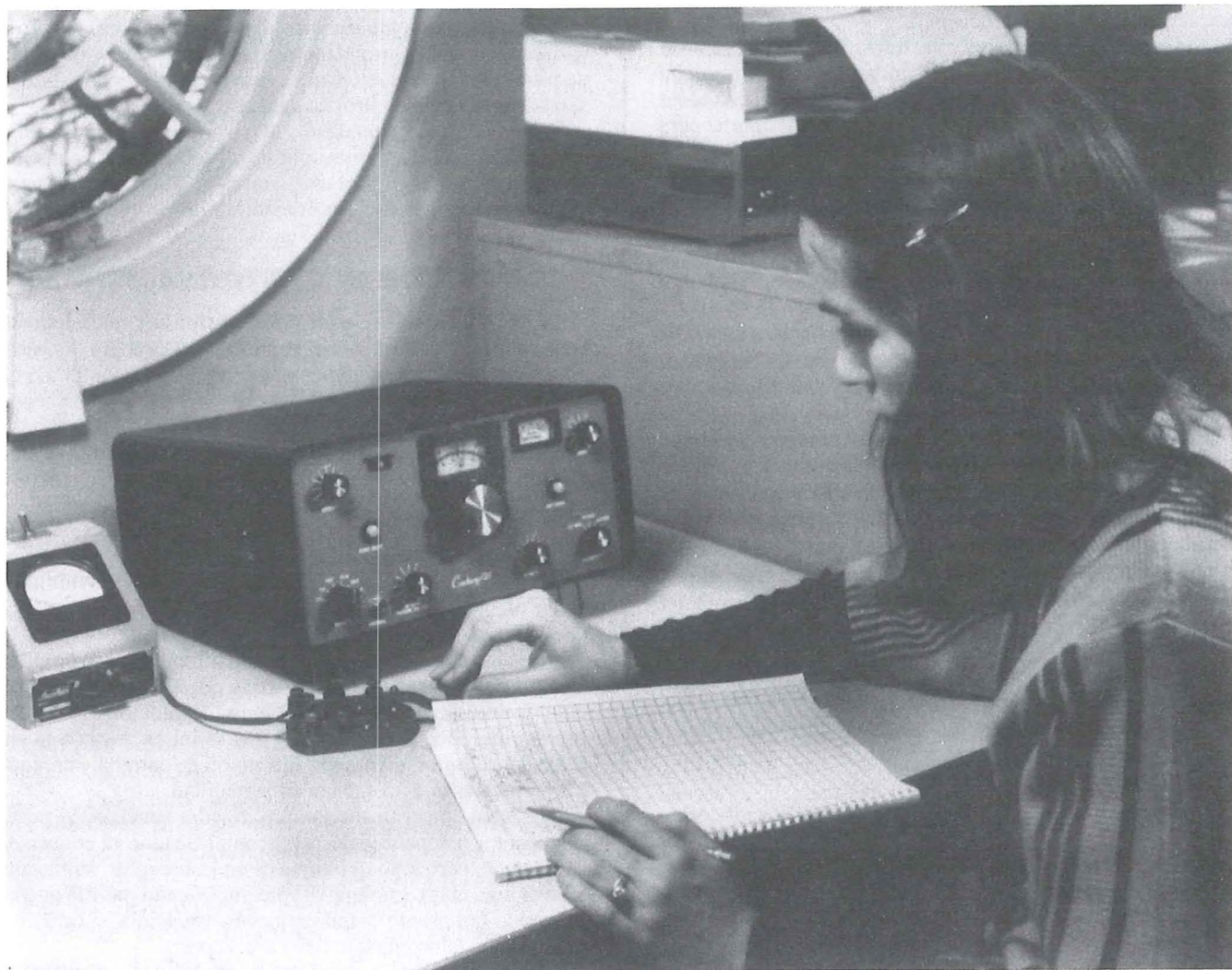
Fig. 54 – El Ten-Tec Century 21 es un transceptor que se puede encontrar en el mercado de ocasión de EE.UU. Este transceptor de estado sólido, únicamente para CW, es muy sencillo de manejar.
