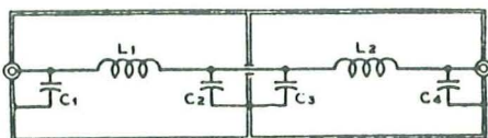
FIG. 19.—Filtro de media onda para 80 m. Los C_1, C_2, C_3, C_4 , de mica plateada o cerámicos y 850 pF. L_1 y L_2 : 13 espiras, 25,4 mm diámetro, hilo núm. 12 esmaltado. Para 40 m, los C todos 440 pF y L_1 y L_2 8 espiras ídem. Para 10 m, los C todos 110 pF y L_1 y L_2 6 espiras 12,7 espiras diámetro a 8 espiras por pulgada.
